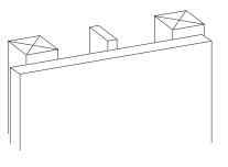
※下地が12mm厚の構造用合板のみの場合は追加で裏から構造用合板 等で補強を行い、下地の総厚を25mm以上としてから施工を行ってく ださい。
